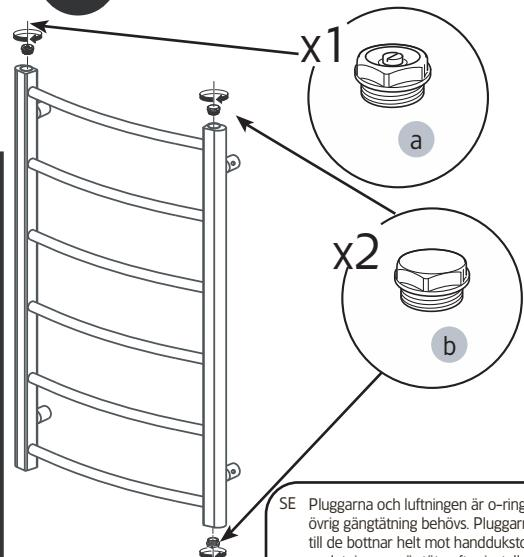
SE Pluggarna och luftningen är o-ringstälade och ingen övrig gängtätning behövs. Pluggarna och luftningen dras till de bunnar helt mot handdukstorken. Kontrollera att anslutningarna är tätta efter installation
